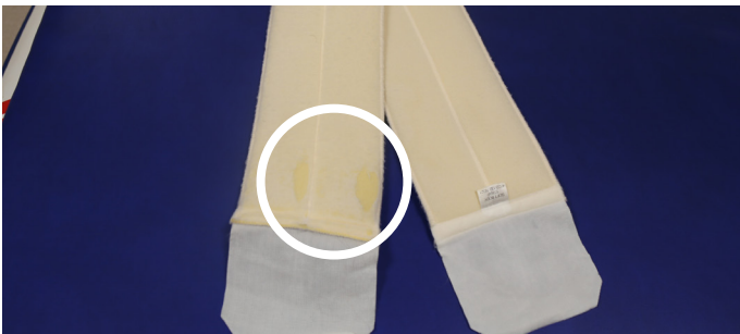
Abbildung 3: Dauerndes Waschen sorgt für schlechteren Kontakt der Klettstelle und unhygienisches Aussehen
