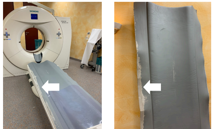
Abbildung 1: Dokumentation der mechanischen Schäden (Pfeil) der Patientenauflage am CT mit starken Abnutzungen des Flügels auf der rechten Seite aufgrund der Umlagerung von bettlägerigen Patienten.
